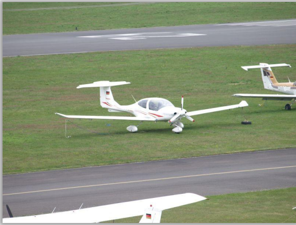
Abb. 10: Die Diamond DA 40 ist ebenso wie die kleinere DA 20 Katana ist eine Tiefdeckerkonstruktion.
