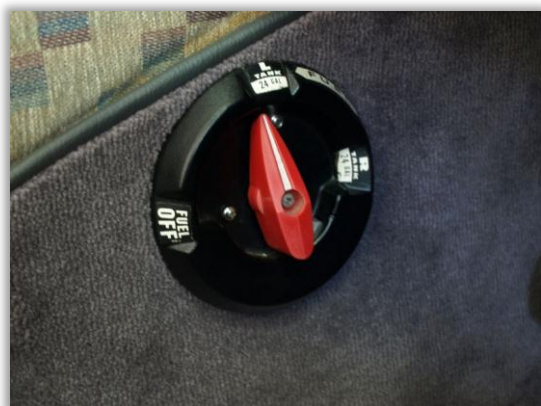
Abb. 75: Der Tankwahlschalter (hier bei der PA28) muss vom Sitz des Flugzeugführers gut zu erreichen sein.
