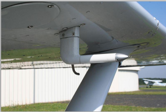
Abb. 95: Das Staurohr einer Cessna 172.
