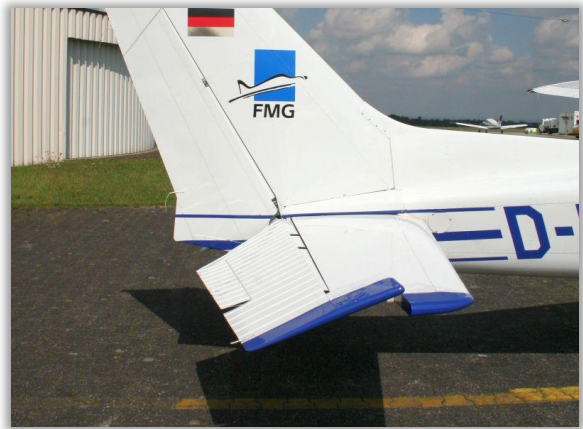
Abb. 16: Der Ruderhorn am Höhenleitwerk bewirkt eine Stabilisierung der Höhenflosse.
