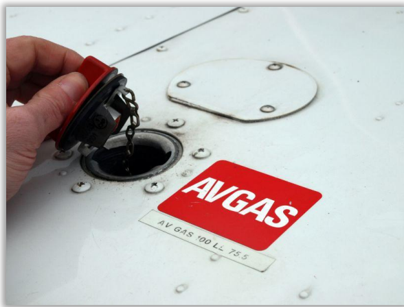
Abb. 70: Am Tankverschluss ist in der Regel ein Hinweis auf den für den Motor zugelassenen Kraftstoff zu finden.
