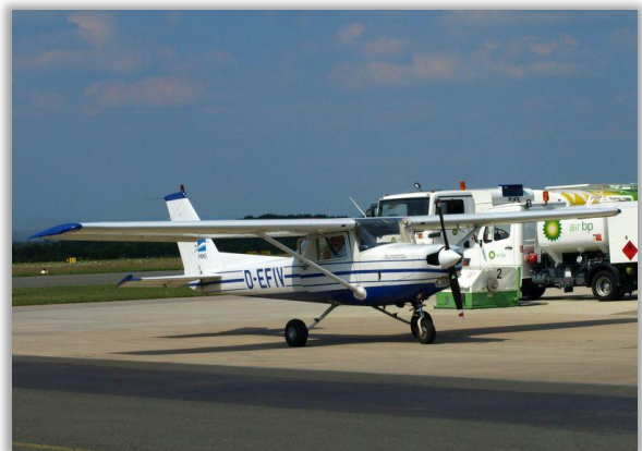
Abb. 9: Die Cessna 150 / 152 ist ein klassisches Beispiel für einen abgestrehten Schulterdecker.
