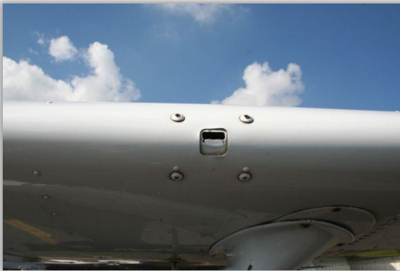
Abb. 7: Die Überziehwarnanlage an der Tragflächenvorderkante löst bei einem zu großen Anstellwinkel einen Ton im Cockpit aus.
