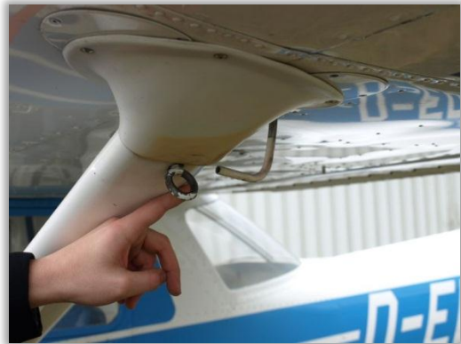
Abb. 74: Die Tankentlüftung sorgt für einen Druckausgleich im Tank des Flugzeuges.
