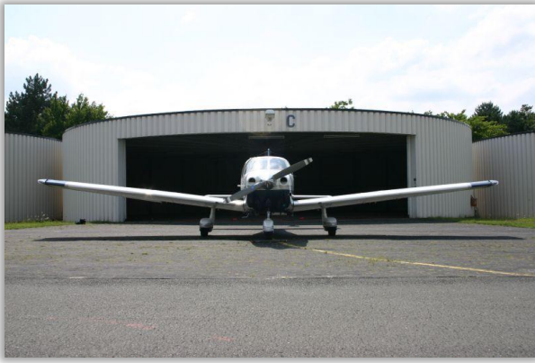
Abb. 14: Eindeutig ist bei der PA 28 Archer die positive V-Form der Tragflächen zu erkennen.
