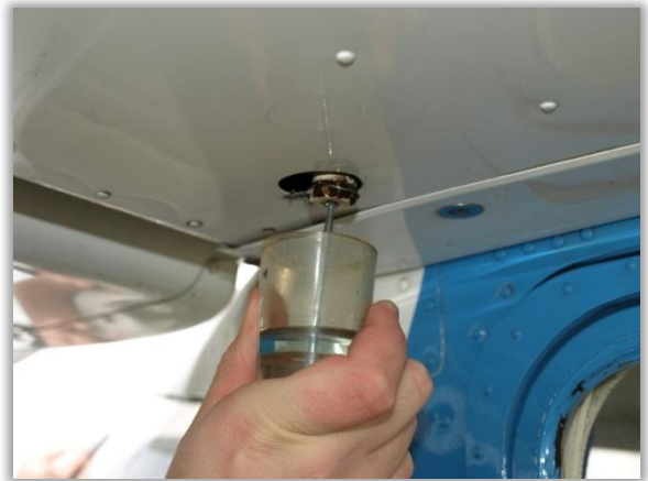
Abb. 71: Das Ablassventil ist an der tiefsten Stelle des Tanks angebracht, um die Wasserrückstände und andere Verunreinigungen im Kraftstoff entfernen zu können.
