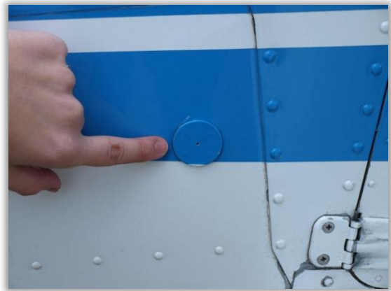
Abb. 94: Die Öffnung zur Entnahme des statischen Drucks ist bei den meisten Flugzeugen an der Seite des Rumpfes angebracht, weil die Luft dort relativ ruhig zu messen ist.
