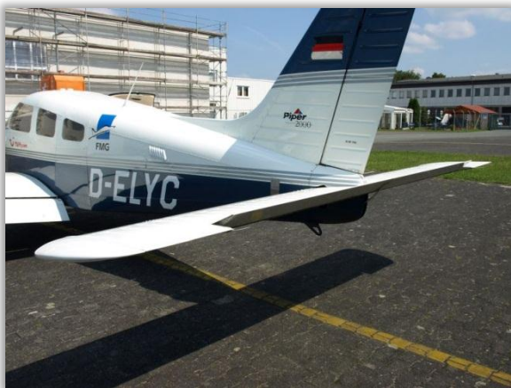
Abb. 15: Bei der Piper PA 28 ist die Höhenflosse als Pendelleitwerk und die Seitenflosse als gedämpfte Leitwerkstruktur ausgelegt.
